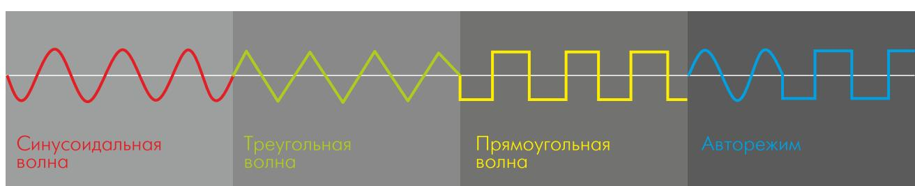
Традиционная, классическая форма волны. Мягкая, менее шумная дуга, обладает эффектом широкого, но в тоже время неглубокого расплавления основного металла.
