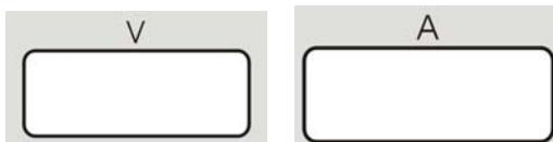
На дисплее справа отображается предварительно заданное значение сварочного тока (A) до начала сварки и фактический сварочный ток во время сварки, а на дисплее слева отображается напряжение (B) на выходных терминалах аппарата.
