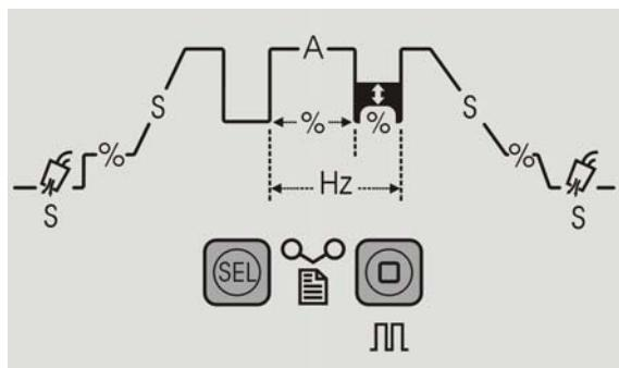
Программируемый контроллер позволяют оператору настраивать характеристики сварки TIG для обеих полярностей - AC (пер.ток) и DC (пост.ток). Нажатие кнопки «Sel» задает цикл по графику процесса.
