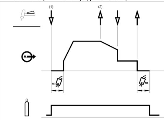
Как показано выше, можно нажать и удерживать курок TIG-горелки второй раз во время понижения тока, чтобы завершить функцию понижения и поддерживать ток сварки при токе кратера. При отпускании курка ТИГ-горелки происходит прекращение подачи сварочного тока и начинается заключительная подача защитного газа. Данная рабочая последовательность (2-шаговая без возможности повторного включения) является заводской установкой.
