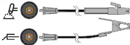
Подключите электродный кабель к терминалу горелки, а зажим заготовки - к терминалу заготовки. Вставьте соединитель с ключом, выровняв его так, чтобы выступ ключа входил в ответный паз, и поверните его на  $\frac{1}{4}$  оборота по часовой стрелке. Не затягивайте слишком сильно.
